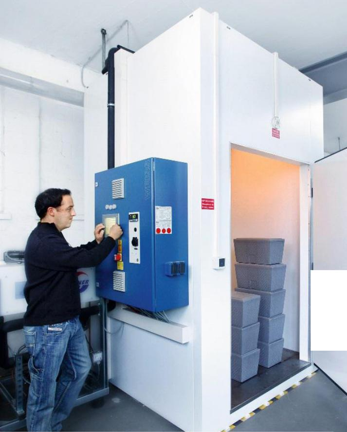
In der unternehmenseigenen Klimakammer werden neu entwickelte Lösungen für den temperaturgeführten Versand getestet.
