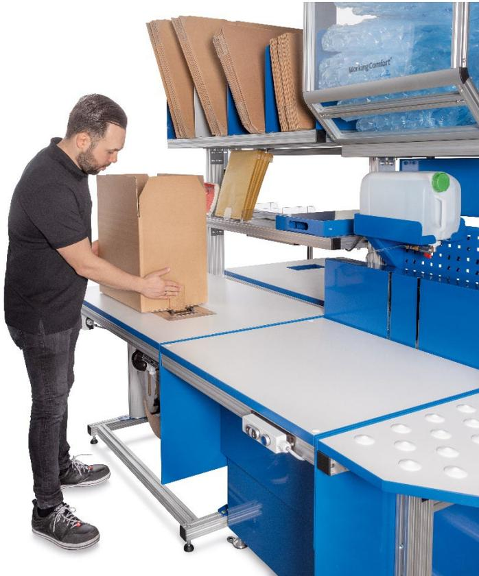
Der Nassklebebandspender für COMFORT.PACK Stationen wird in die Oberfläche des Paktisches integriert, sodass sich Versandkartons schnell und einfach über den Spender führen lassen. Bild:Storopack
