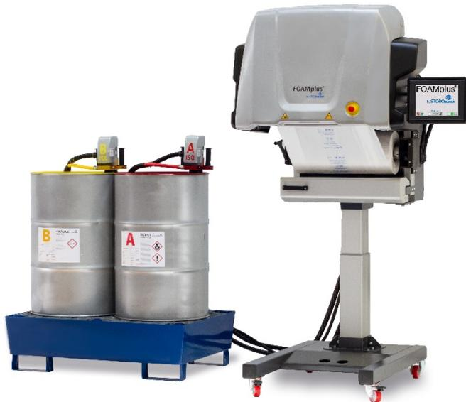
Der FOAMplus® Bag Packer<sup>3</sup> liefert mit individuell produzierbaren Schaumpolsterbeuteln Schutzverpackungen für etliche Anwendungen.
