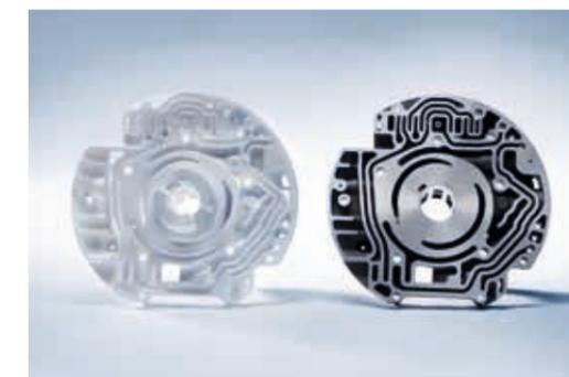
Cover Pump (Schäumling und Gussteil)
