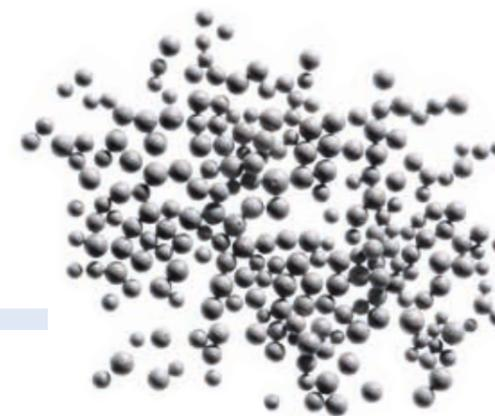
**Neopor®** ist eine mit Graphit versetzte Variante des Styropor®. Es hat die niedrigste Wärmeleitzahl aller expandierbaren Schäume. Wenn eine der Hauptaufgaben des Formteils die Isolationswirkung ist, kommt Neopor® zum Einsatz.
