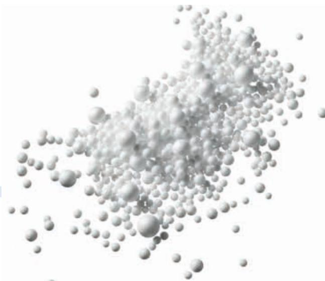
**Expandierbares Polystyrol (EPS)**, auch bekannt unter dem Markennamen Styropor®, ist vielfältig einsetzbar und besonders leicht, da es zu 98 Prozent aus Luft besteht. EPS absorbiert Energie bei Stößen und isoliert gut gegen Wärme und Kälte.
