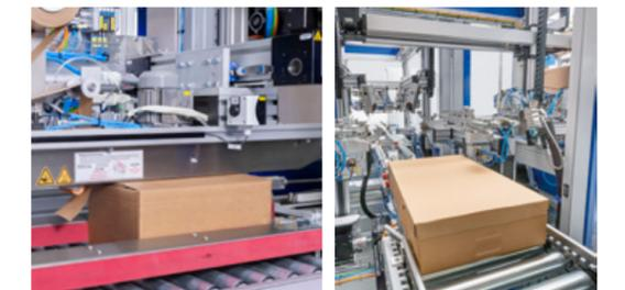
4. VERSCHLIESSEN MIT SELBST- ODER NASSKLEBE BAND UND\*/ODER MIT DECKEL
