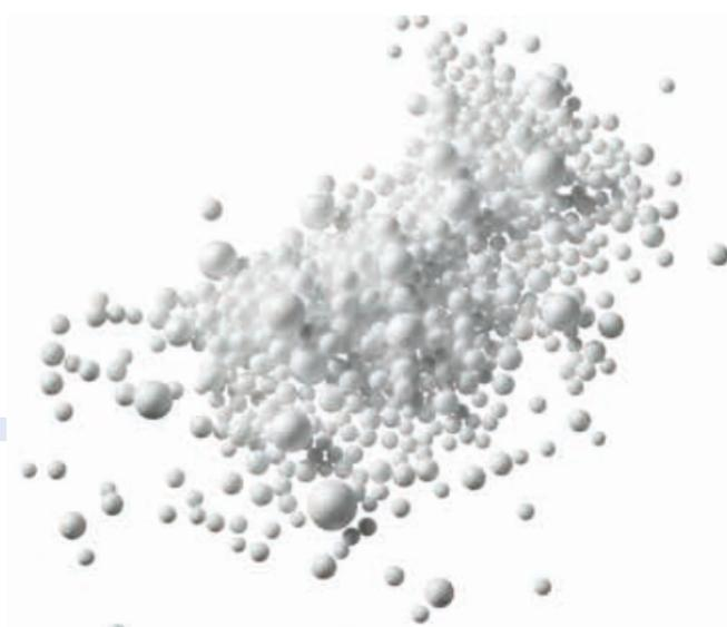
**Styropor®** ist ein Alleskönner. Günstige und dabei hygienische Schutzverpackungen schützen zuverlässig alle empfindlichen Produkte. Styropor® ist außerdem besonders leicht, da es zu 98 Prozent aus Luft besteht. Wärmeleitfähigkeit bis zu 0,032 W/(mK).
