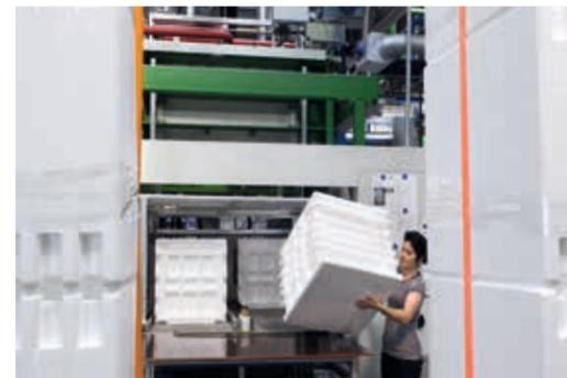
Stapelung der Verpackungsformteile auf Paletten
