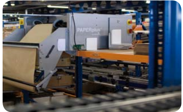
Eine Classic Maschine, integriert in ein Pick-to-Light-Bücherlager.
