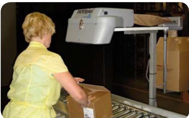
Eine modifizierte Shooter Maschine an einem Schwenkarm führt das Verpackungsmaterial näher zum Mitarbeiter.
